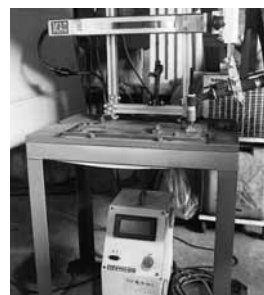
導入した自動溶接機ユニット
