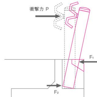
せん断破壊メカニズム図
