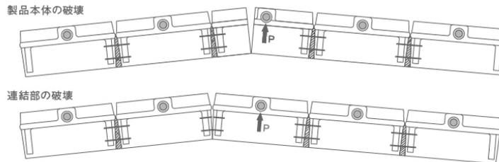
図-2 プレガードの縦方向の破壊形態
