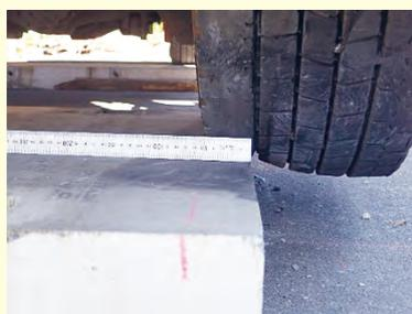
ガードレールに車両が衝突し、輪荷重(タイヤ)がプレガードⅡの天端に50mm残った場合のタイヤの傾きと沈下量
