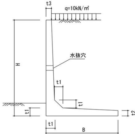
※ 擁壁背面が水平な場合の規格・寸法です。勾配がついている場合には別途検討が必要です。また擁壁たて壁の天端幅は8cmと薄いため、防護柵を設置する場合には独立防護柵基礎が別途必要です。
