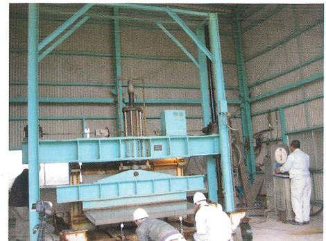
曲げ破壊試験の実施状況
