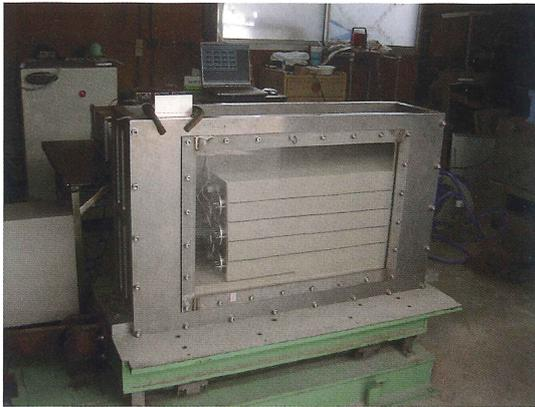
使用した振動台実験装置と土槽
