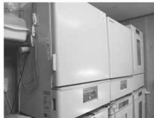
① インキュベータ 成熟したアオノリから胞子を採取し、種苗を生産するための培養設備
