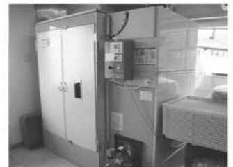
⑥ 食品乾燥機 収穫・脱水したアオノリを温風で乾燥させるための設備
